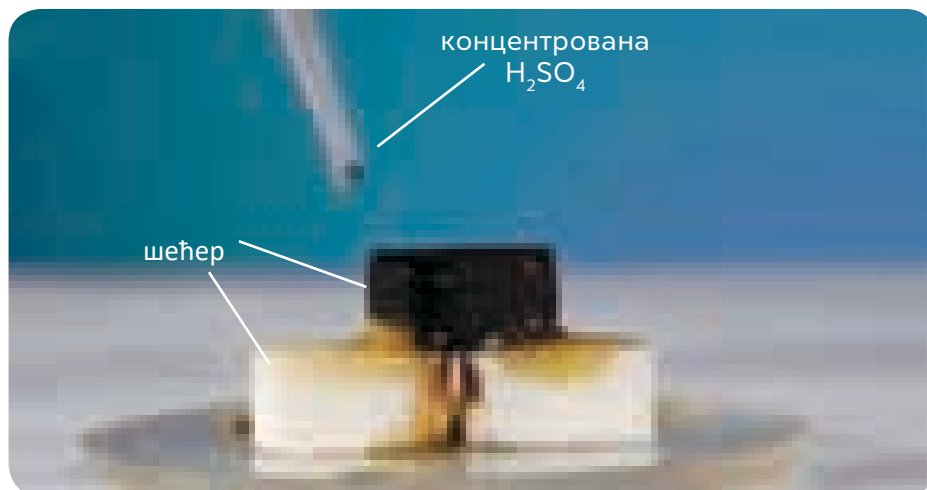
Слика 2.34. Шећер угљенише када на њега додају пар капи концентроване сумпорне киселина.
