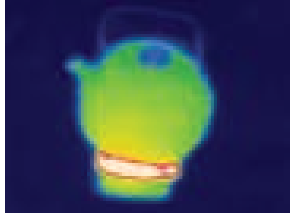
Şekil 1. Ocak üzerinde bulunan bir su ısıtıcısının termal görüntüsü. Farklı renk ve tonlar, su ısıtıcısının farklı bölgelerindeki sıcaklıkları gösterir. Beyaz ve kırmızı renkli bölgeler en yüksek, mavi renkli bölgeler ise en düşük sıcaklığa sahiptir.
