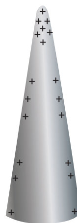
Слика 9. Распоред наелектрисања код зашиљеног проводника
