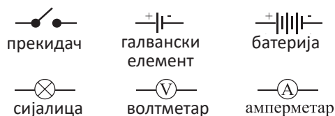
Слика 6. Символи за елементе струјног кола
