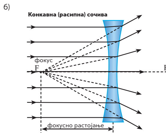
Слика 5. а) Сабирно сочиво. Након преламања кроз сочиво снопа зрака паралелних главној оптичкој оси, они пролазе кроз његов фокус који је са друге стране сочива. б) Расипно сочиво.
