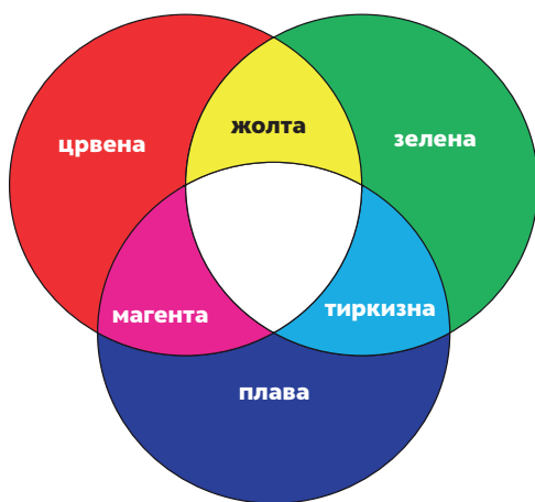
Слика 1. Адитивно мешање основних боја. Три светлосна извора су усмерена ка екрану. Централни део слике где се адитивно мешају три основне боје је бео. Мешање две основне боје ствара изведену боју.
