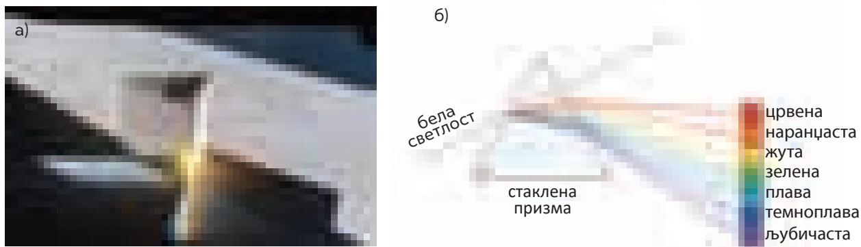
Слика 2. а) Дисперзија беле светлости од стаклене призме б) Графички приказ преламања беле светлости кроз призму
