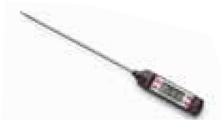
Foto 2. (a) Pamja e një termometri të lëngshëm. Lëngu mund të jetë alkool ose merkur. b) Termometri dixhital i sondës metalike
