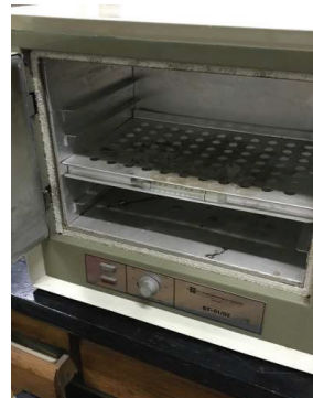
Fig. 4.6 Tharëse me termostat për rregullim të temperaturës.
