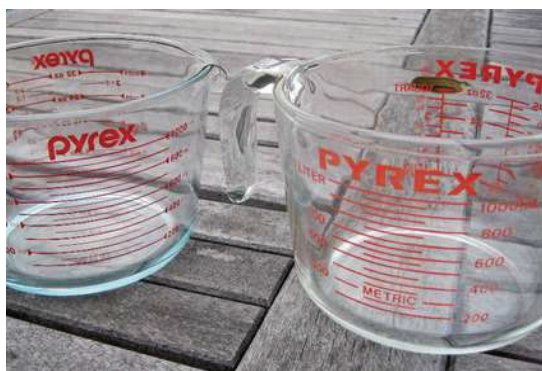
Fig. 2.3 Pajreks është lloji i qelqit më i përdorur borosilikat
