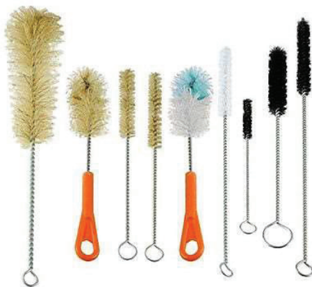
Fig. 2.14 Brusha për larjen e pajisjeve laboratorike prej qelqi
