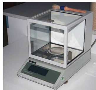
Fig. 3.21. Peshorja digjitale analitike
