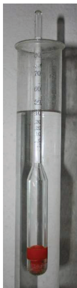
Fig. 3.30 Me aerometër matet dendësia e lëngjeve
