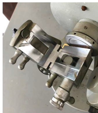
Fig. 4.33 Prizmat te refraktometri i Abeovit
