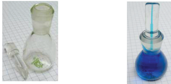
Fig. 3.29 Piknometër i zbrazët (a) i mbushur (b)
