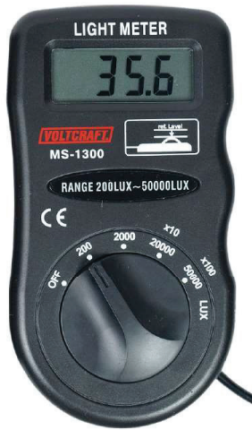
Fig. 4.27 Matësi i dritës për fotografi (një lloj fotometri)
