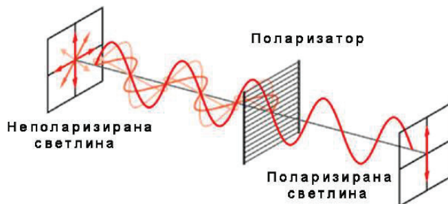
Fig. 4.37 Polarizimi i dritës-paraqitje skematike
