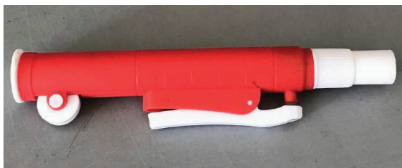
Fig. 3.25 Klip (a) dhe prej gome (b) për pipetim
