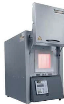
Fig. 4.7 Furra e Muflovit me termostat për rregullimin e temperaturës.
