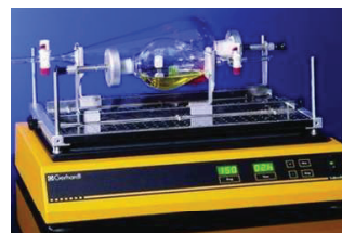
Fig. 4.14 Mikseri me platformë vibruese
