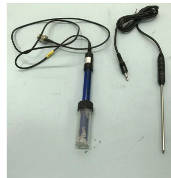
Fig. 4.26 pH-metri zhvendosës digjital, me interfejs për kyçjen e kompjuterit (a) seri pufërësh për kalibrim b), sensorë për pH, (c) dhe sensorë për temperaturë (d).
