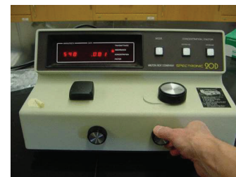
Fig. 4.30 Spektrofotometri që mund të punojë në një gjatësi valore sipas zgjedhjes së eksperimentuesit.
