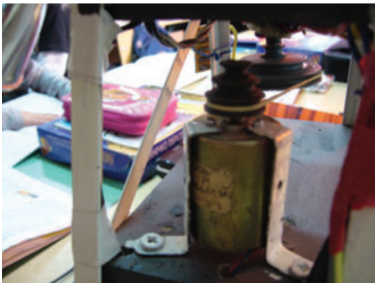
Zbatimi i elektromotorit me mekanizëm transmetues
