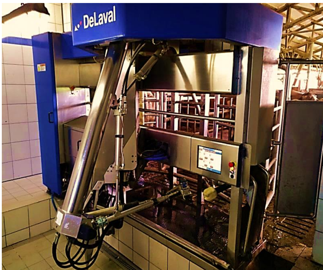
Fig. 2-23. Roboti për mjeljene lopëve DeLaval
