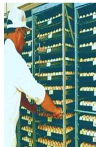
Fig.6-23. Rënditja e vezëve në inkubacion në rrllej karrocën dhe vënia në inkubator
