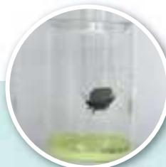
Magnetizam gvožđa omogućava da se odvoji magnetom kada je u smjesi.
