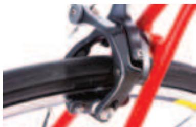
Prilikom stiskanja kočnica na biciklu, gumene pločice se trljaju sa metalnim dijelom točka.
