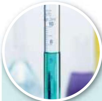
Zakrivljena površina tečnosti naziva se meniskus, a volumen očitavanja u ovom slučaju je 7 ml. (Od jednog do drugog podjelka na skali, razlika je 0,2 ml.)
