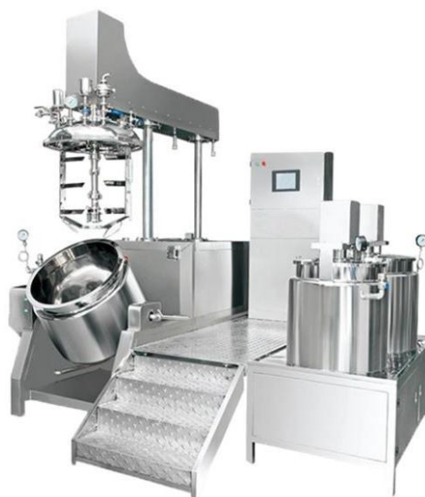
Figura 29. Mikser – makinë për prodhimin e kremrave
