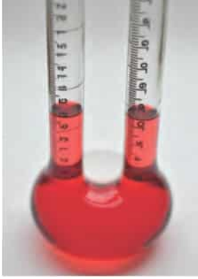
Resin 7 - sıvılı manometre
