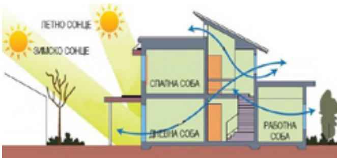
Осончување и проветрување на просторот
