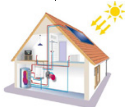
Систем за греење со помош на сончеви колектори
