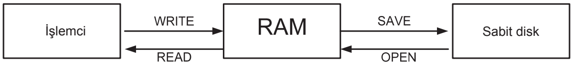
Resim 2.5. RAM'ın mikroşlemcide çalışma belleği olarak işlevi
